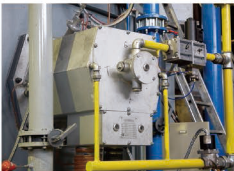
REGFIRE®-Brenner an einem Dreh- herdofen zum Schmieden von Ringen REGFIRE®-burner on a rotary hearth furnace for forging of rings
