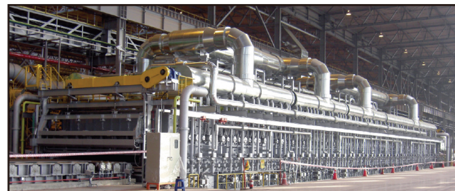
RECUFIRE® 辐射管在辊底炉 (厚钢板生产) 的应用 RECUFIRE® radiant tubes on a roller hearth furnace for plate
